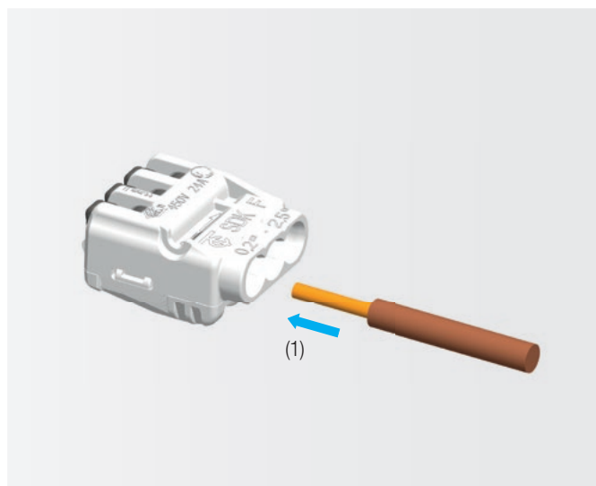
Für starre Leiter ist es nicht notwendig, den Hebel vor dem Einstecken des Leiters zu öffnen For rigid wires it is not necessary to open the lever before pushing in the wire
