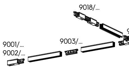
Anche le testate ed i giunti di collegamento presentano una chiave meccanica (presenza vite - vedi figura sotto) che deve essere tenuta in considerazione per la scelta del giusto componente.
