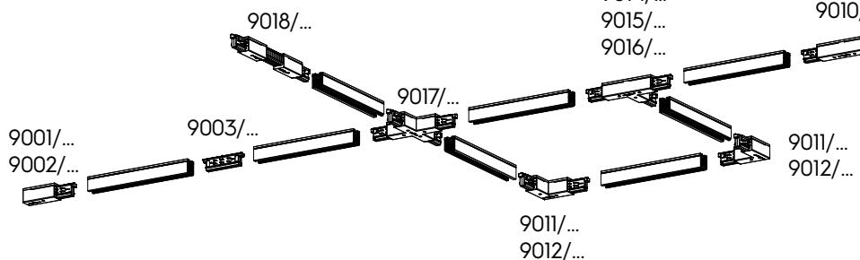
Anche le testate ed i giunti di collegamento presentano una chiave meccanica (presenza vite - vedi figura sotto) che deve essere tenuta in considerazione per la scelta del giusto componente.
