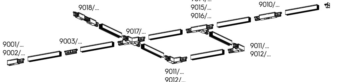
Anche le testate ed i giunti di collegamento presentano una chiave meccanica (presenza vite - vedi figura sotto) che deve essere tenuta in considerazione per la scelta del giusto componente.
