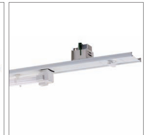
VLM-K11 600 ... Notlichtmodul für Kompaktleuchtstofflampe TC5 bis 11 Watt. Ausführung 7-polig, Farbcodierung lila, zur Montage in VLT-7 Ausführung 11-polig, Farbcodierung grün, zur Montage in VLT-11 zur Auswahl zwei separater Notlichtkreise
