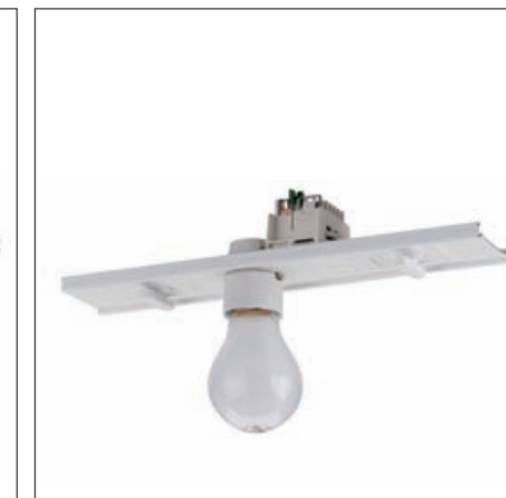
VLM-E27 300 ... Notlichtmodul mit E27-Fassung. Ausführung 7-polig, Farbcodierung lila, zur Montage in VLT-7 Ausführung 11-polig, Farbcodierung grün, zur Montage in VLT-11 zur Auswahl zwei separater Notlichtkreise
