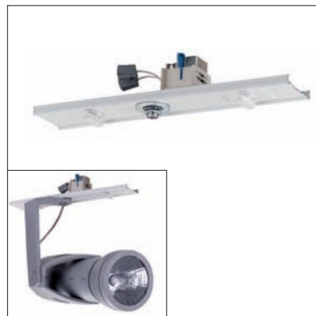
VLM-SD 300 ... zur Aufnahme von Strahlern aus dem RIDI-Programm. Ausführung 5-polig, Farbcodierung blau, zur Montage in VLT-5, VLT-7 oder VLT-11
