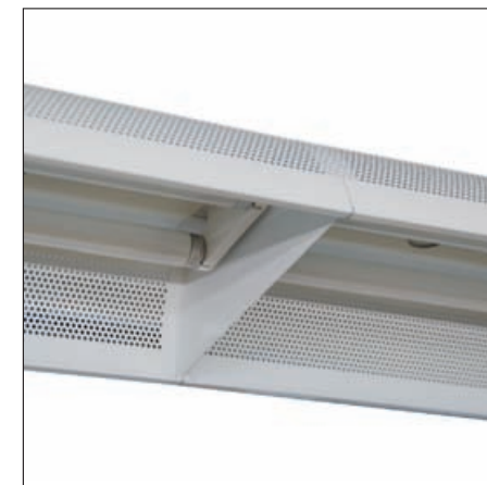
Reflektor-Zwischenwand VLRZW für Lichtbänder RIDI LINIA (T26) zum Einrasten in die Reflektorverbinder. Sie dient als optische Unterbrechung des Lichtbandes und zur Längsentblendung.
